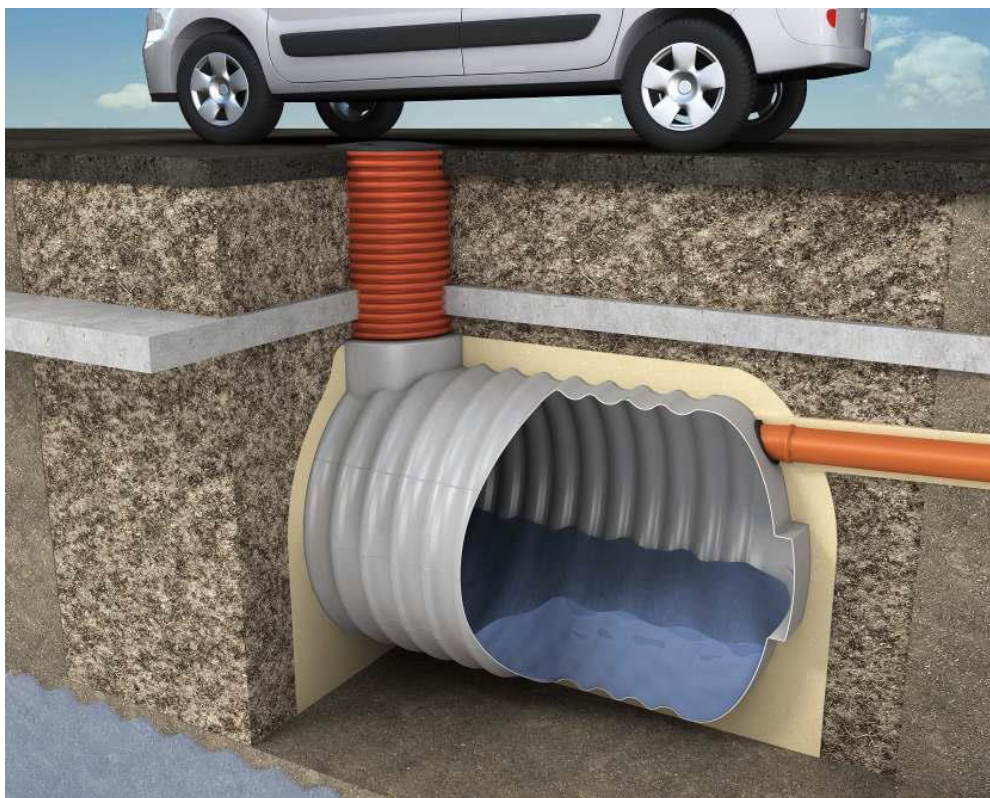
Obr. 4: Správne prevedenie betónovej platne 2
