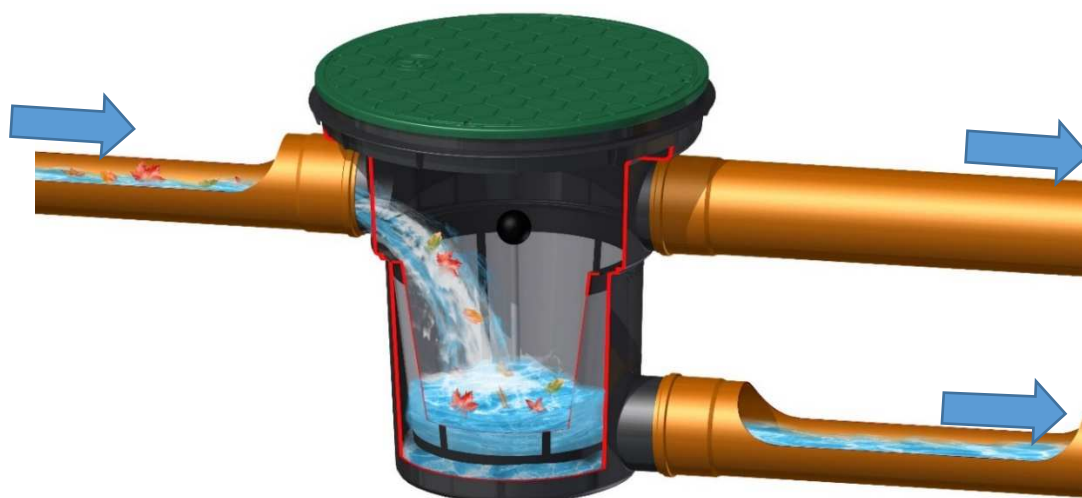
Obrázok 12: Prepadový filter dažďovej vody D400 AQ – prevádzkový diagram
